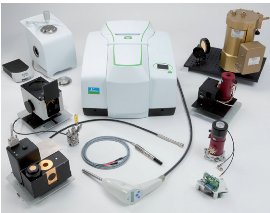
中红外、近红外或远红外附件可以与Frontier双光程仪器结合使用
