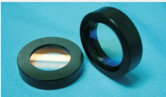
(1) 半波片：偏振光通过二分之一波片后，仍为线偏振光，但是，其合振动的振动面与入射线偏振光的振动面转过 $2\theta$ 。
