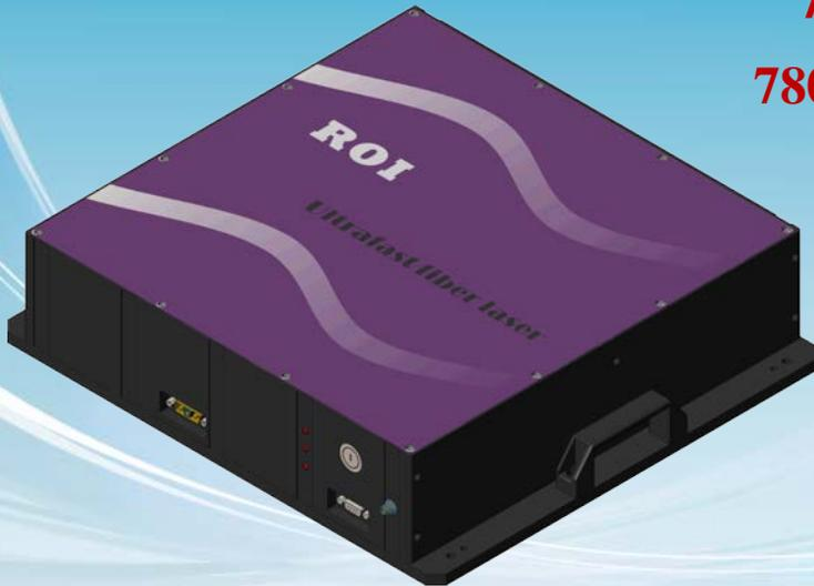
上海朗研光电科技有限公司创新推出的高功率（HP）飞秒光纤激光器，输出波长为780或1560nm，典型脉冲宽度120fs，重复频率80MHz，最高平均功率800mW@780nm（1400mW@1560nm）。基于完美的全自动锁模脉冲、特有的低噪声光纤放大技术、高效率的非线性倍频技术、可靠的泵浦保护技术，使得该光纤激光器具有极佳的长期稳定性和可靠性。该产品为光电一体化设计，接触式被动散热，无冗余控制模块；可近程turn-Key启动，亦可远程软件控制。该产品可提供低功率和高功率两种配置，实现性价比最优化，可应用到THz光谱、生物医学、光通信等应用领域中。
