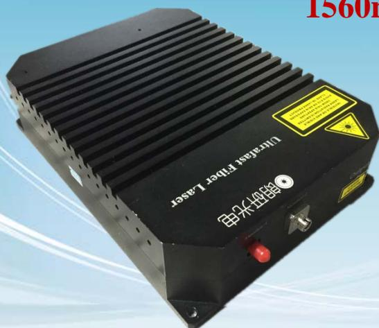
朗研光电最新推出的新型飞秒/皮秒光纤激光器模块，输出波长为1.56 $\mu$ m 波段，脉冲宽度小于100fs，重复频率20-100MHz可定制。该光源基于完美的泵浦保护技术，全保偏光纤可饱和吸收体锁模技术，低非线性、低噪声光纤放大技术，实现了小型一体化设计，具有极高的可靠性和稳定性。该产品可满足客户系统集成方面的应用需求，性价比高，可应用到THz光谱、生物医学成像、光通信、工业激光种子源等应用领域中。
