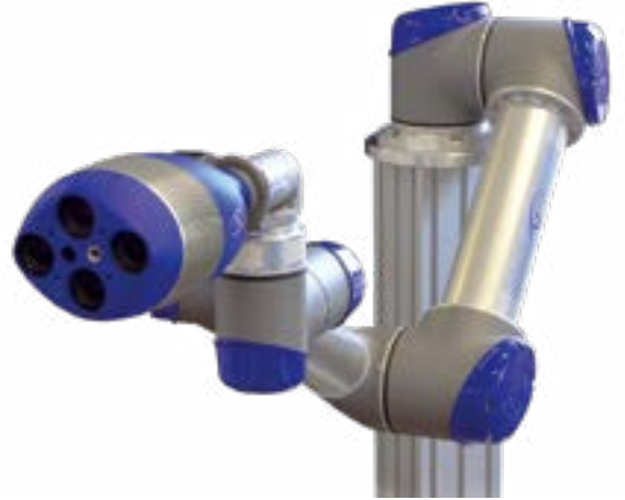
安装在机械臂上的紧凑抖盒子测试系统 MiniShaker Aero型
