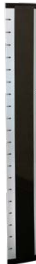
空气动力学性能优化的充氮肥皂泡（HFSB）直线型喷嘴阵列
