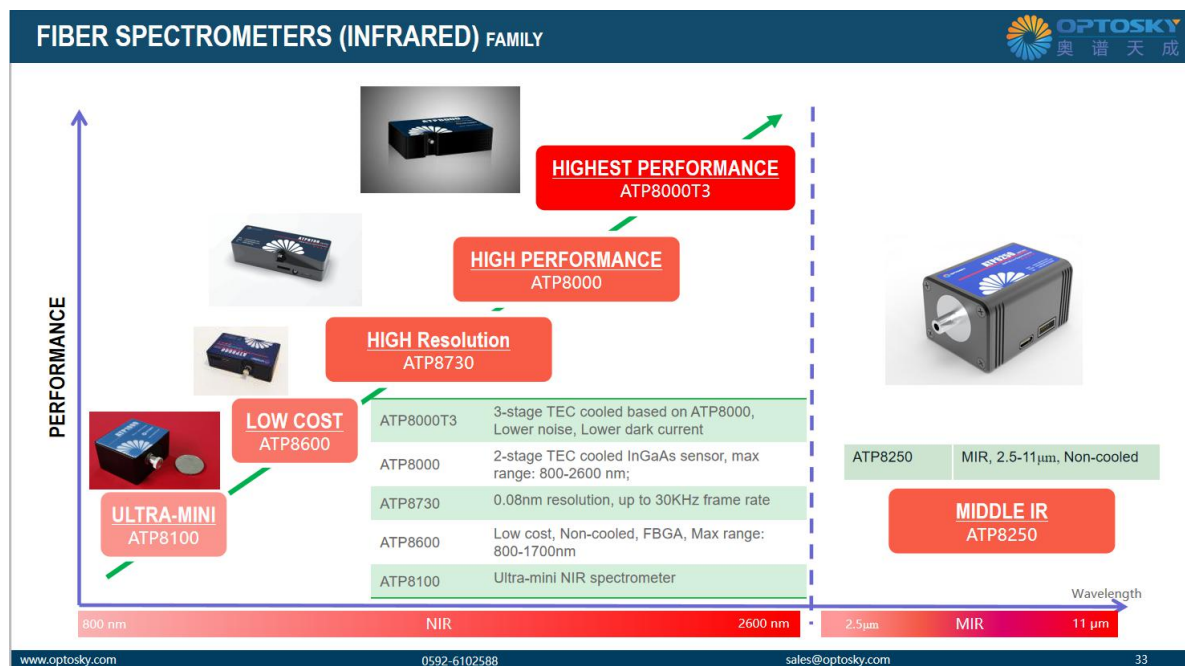
图 10 奥谱天成生产的（短波红外、中波红外）光纤光谱仪系列
