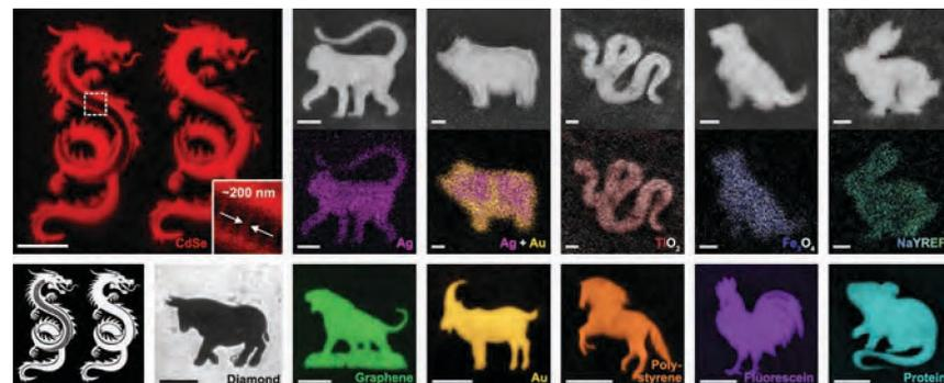
图 3. 通过十二生肖展示材料多样性，包括 CdSe 量子点的双龙在未收缩荧光图像（插图显示分辨率为 ~200 nm）；Ag 的猴的 SEM（上）和 EDX（下）图像；Au-Ag 合金的猪；TiO<sub>2</sub> 的蛇；Fe<sub>3</sub>O<sub>4</sub> 的兔；NaYF<sub>4</sub> 的牛；钻石的牛的光学显微镜图像；石墨烯量子点的老虎的荧光图像；荧光金的山羊；聚苯乙烯的马；荧光素的公鸡；荧光蛋白的鼠。
