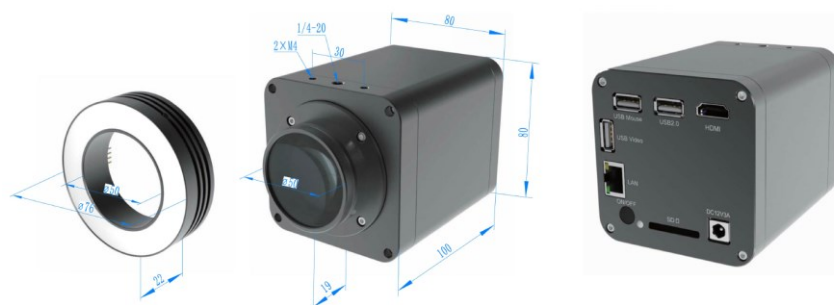
图 1-3 AFDM411 外形尺寸示意图
