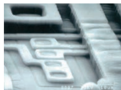
去除上层后的IC表面SEM照片
