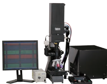
使用VMU-L4B进行的UV激光加工 (照片提供: V-Technology Co.,Ltd.)
