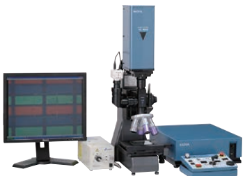
使用VMU-L4B进行的UV激光加工 (照片提供: HOYA CANDEO OPTRONICS株式会社)
