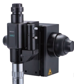
图片：在VMU-V上安装的示例(对焦单元A) (物镜为选件)
